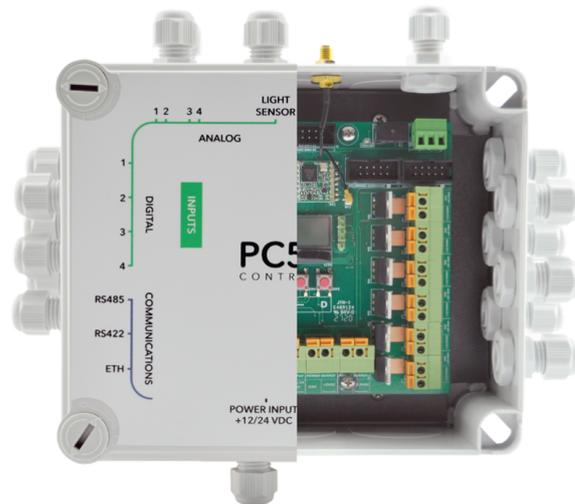
El controlador ML-C500 le permite configurar todos los parámetros de funcionamiento de las balizas o señales de tráfico.
