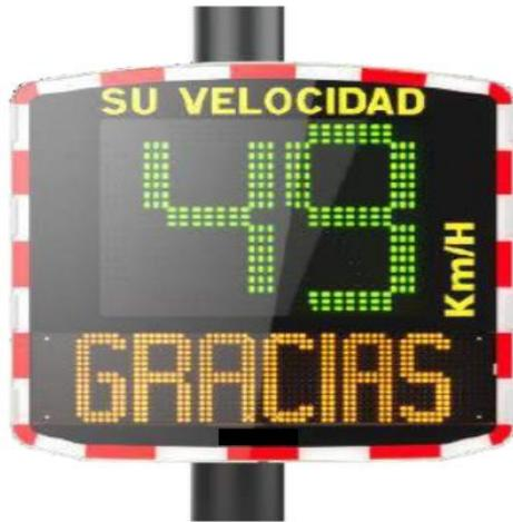
La velocidad es detectada por la antena DOPPLER situada en el interior de la caja. El radar emite ondas que van dirigidas al primer vehículo en movimiento. La variación de frecuencia permite calcular la velocidad exacta del vehículo en el campo visual del radar.
